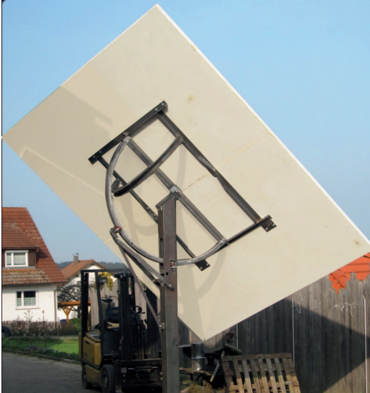
Projekt Auto-R: erster Radkranz-Heliostat-Prototyp mit primärer Horizontalachse mit zunächst 8 \text{ m}^2 Spiegelfläche.
