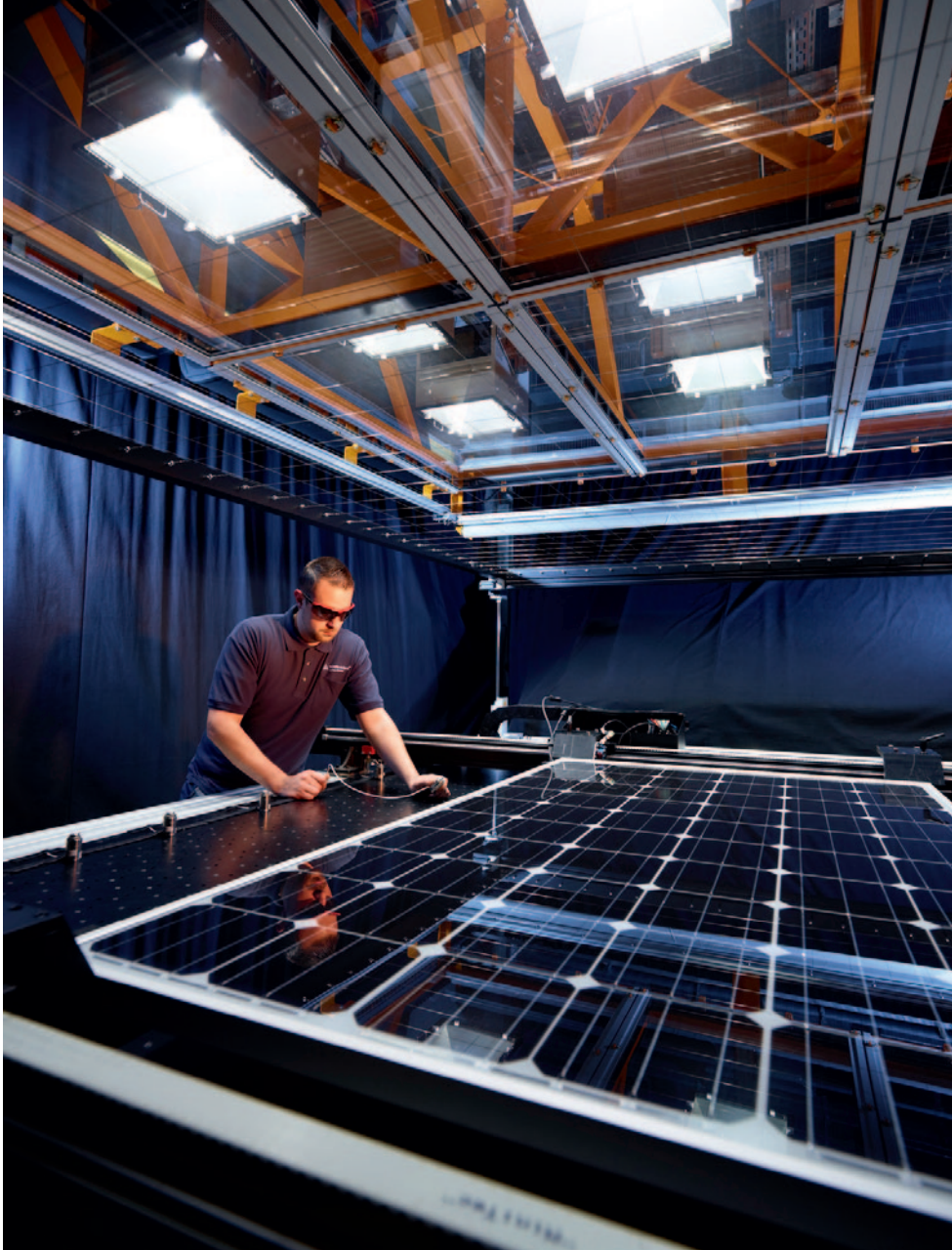
Prüfstand Sonnensimulator des TÜV Rheinland.
