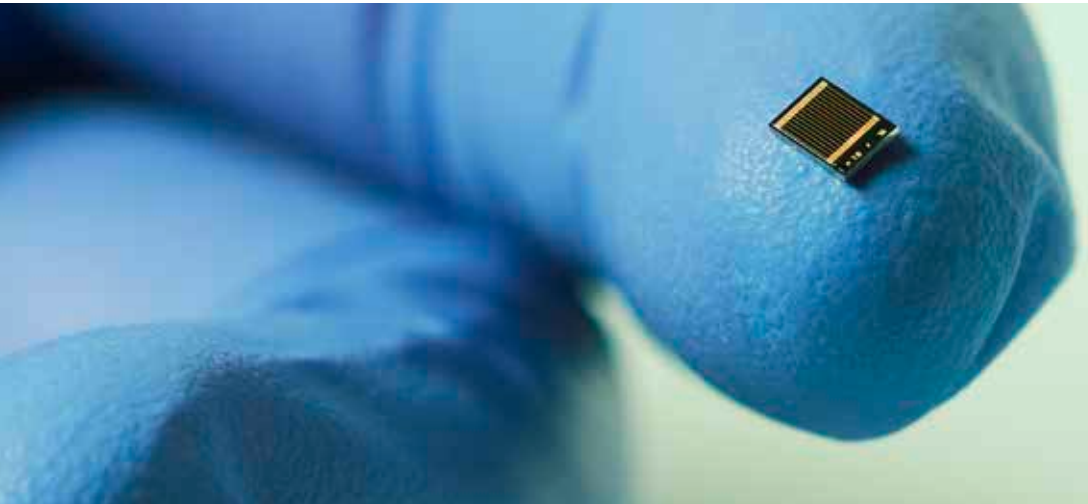
Weltrekordsolarzelle mit 44,7 Prozent Wirkungsgrad, bestehend aus vier Teilsolarzellen auf Basis von III-V Halbleitern, für die Anwendung in der Konzentration-Photovoltaik.
