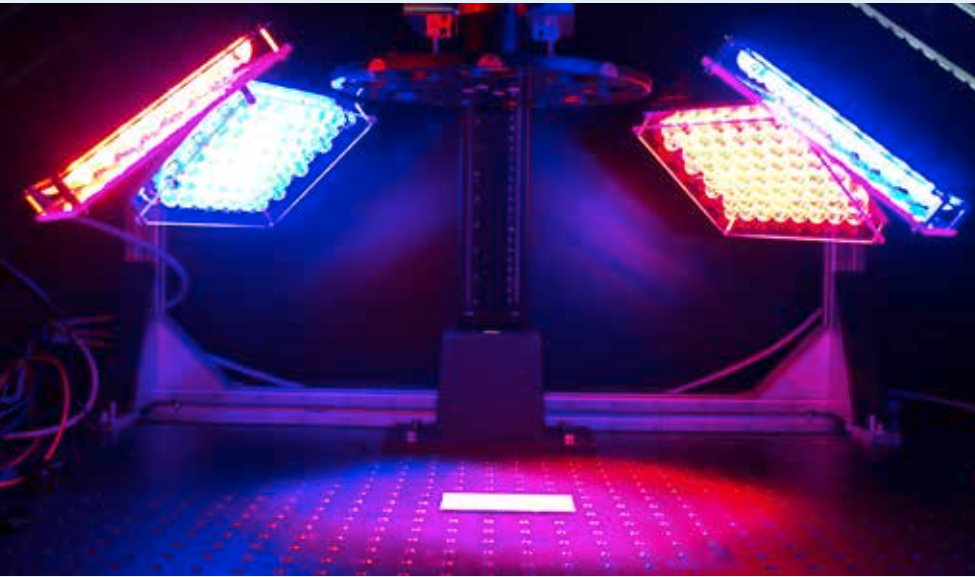
Untersuchung des Langzeitverhaltens von CIS-Dünnschicht-solarzellen mittels Temperatur-, Beleuchtungs- und elektrischen Belastungstests
