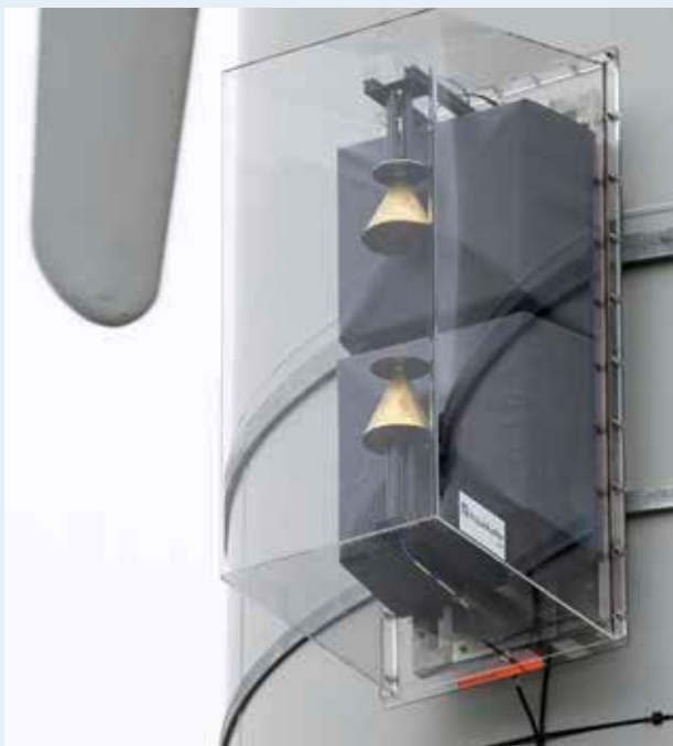
Das PARASOL-System nutzt Passiv-Radar-Sensoren für die Detektion sich annähernder Flugzeuge.
