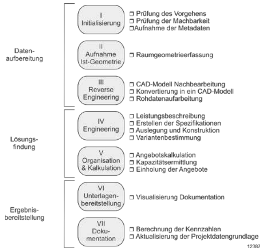
Abbildung 12: Angebotserstellungsprozess für Retrofit-Maßnahmen [12]
