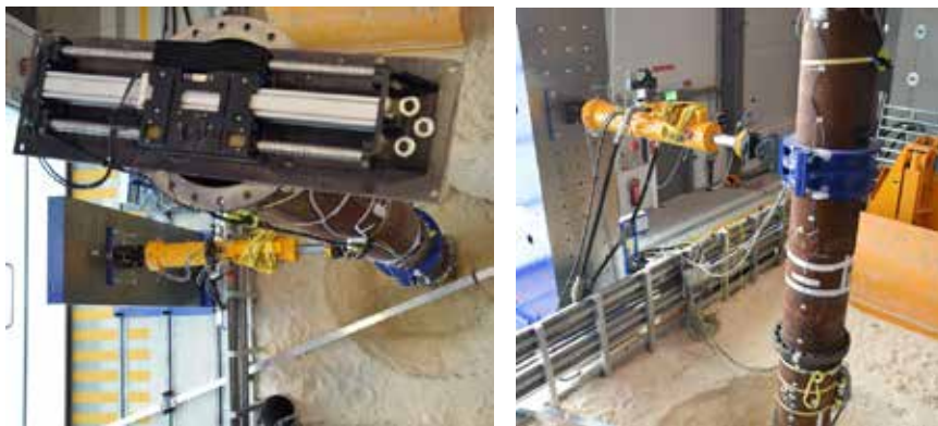
Abbildung 3: Foto des Versuchsaufbaus mit den Lasteinleitungssystemen elektrodynamischer Shaker (links) und Hydraulikzylinder (rechts)
