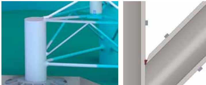
Abbildung 12: Position der Überwachungsbereiche; links: an der Struktur, rechts: Sensorposition bezüglich des zu erwartenden Fehlers
