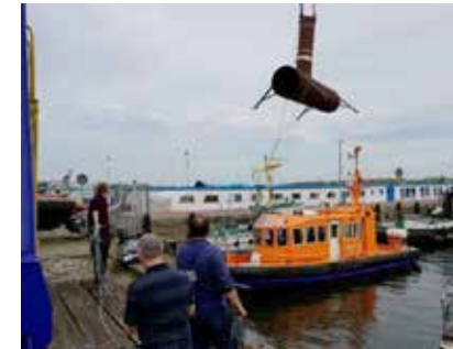
Abbildung 15: Rohrknotten mit Sensormanschette beim Versenken im Hafenbecken
