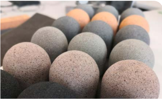
Probegeometrien aus Kernsand mit verschiedenen Aerogel-Additiven
