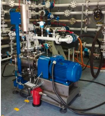
Abb. 5: Versuchsaufbau des zweiflutigen CGC-Demonstrators bei der Erprobung
