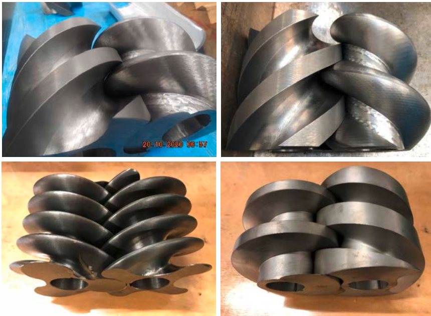
Abb. 1: Profilvarianten asy-SRM (oben links) und sym-SRM (oben rechts) profilierte 2/4 gängige Schrauben sym-SRM profilierte 3/4 gängige Schrauben (unten links) LW-profilierter 1/2 gängige Schrauben (unten rechts)
