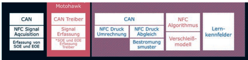
Abb. 6: Injection Control Unit (ICU) als Hardwareübersicht
