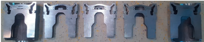
Abb.13: visionärer Leichtbaukolben mit einem Durchmesser 160 mm
