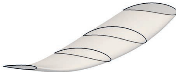
Abb. 2: Darstellung des Aufbaus des HiOfoils mit Profilschnitten
