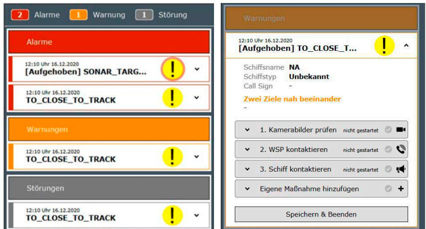
Abb. 10: Bildausschnitt Alarmfenster und Detailsicht mit Maßnahmen
