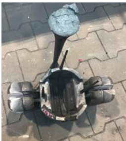
Abb. 14: Kolbenunterteil aus MCG35
