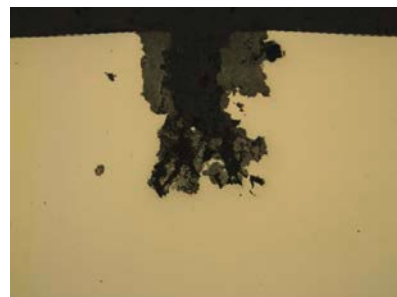
Abb. 17: Metastabile Lochkorrosion ohne Rissbildung (100:1)
