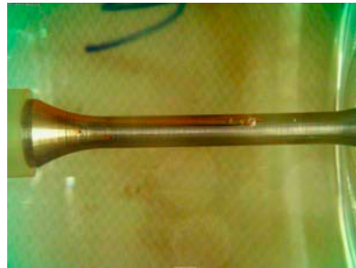
Abb. 19: Wasserstoffblasen an SSRT-Probe
