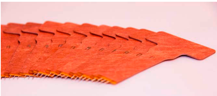
Abb. 2: Scherwellenwandler mit Schirmung und male pinout
