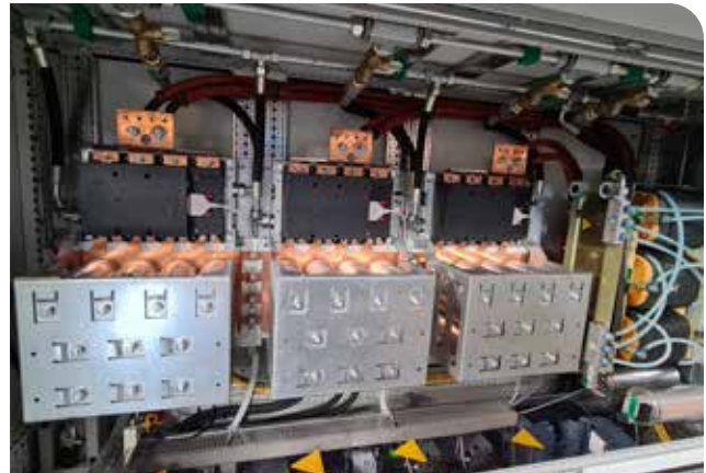
Das Foto zeigt die drei integrierten Phasenbausteine eines 400-kVA-Demonstrator-Stack-Wechselrichters von Infineon.
