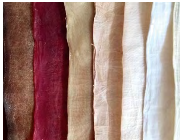
Aus mikrobiell hergestellten Spinnenseideproteinen stellt AMSilk Textilfasern her (li). Lederimitat aus bakterieller Nanocellulose von ScobyTec (re.)
