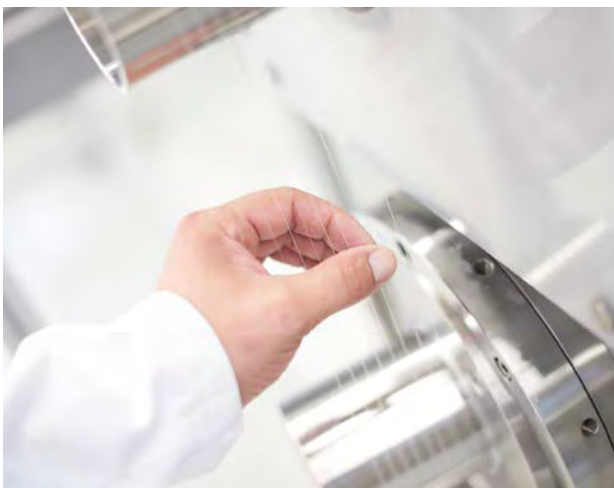
Aus mikrobiell hergestellten Spinnenseideproteinen stellt AMSilk Textilfasern her (li). Lederimitat aus bakterieller Nanocellulose von ScobyTec (re.)
