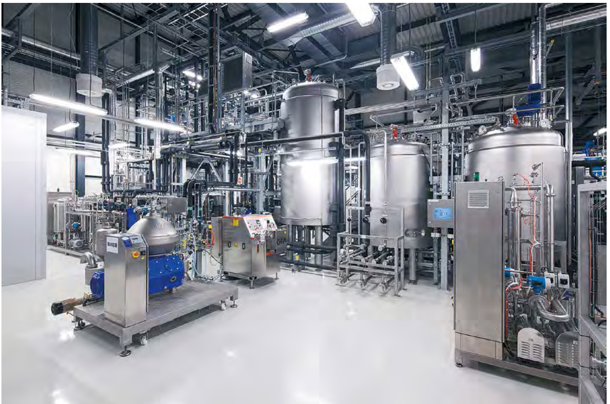
Am Fraunhofer-Zentrum für Chemisch-Biotechnologische Prozesse CBP in Leuna wird Holz in seine chemischen Einzelteile zerlegt.
