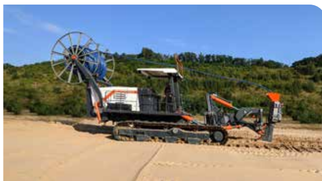
Der Kollektorweber wird auf einem Versuchsfeld auf seine Praxistauglichkeit getestet.
